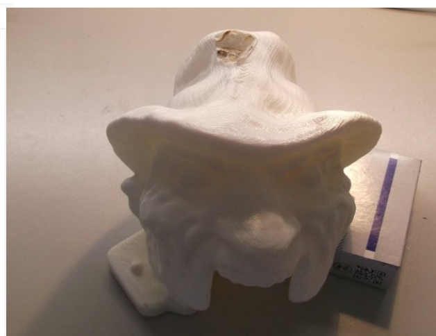
Rohling fertig ausgedruckt
